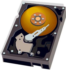
**HDD(ハードディスクドライブ)**は内蔵されている磁気ディスクを回転させ、磁気ヘッドが移動し、目的のデータを読み書きします。
