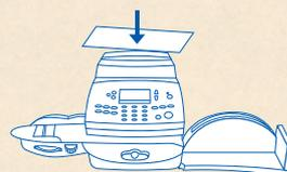
**Step 2** 郵送物を機械に通すと、Step.1で算出された郵便料金が印字されます。
