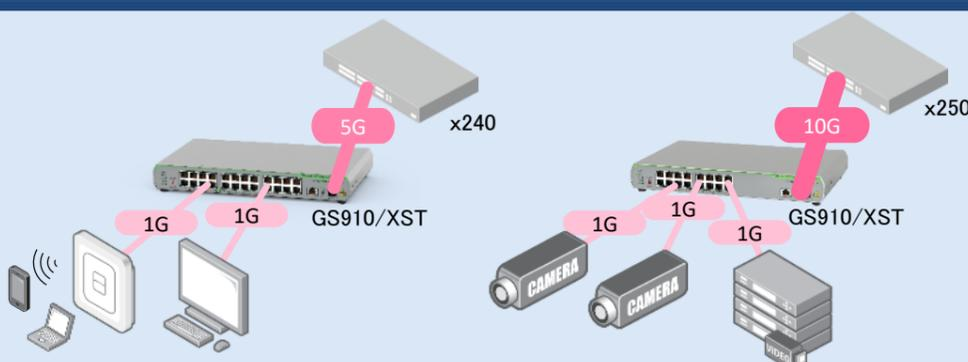
AT-GS910/XSTシリーズは、アップリンクにマルチギガ対応10Gポートを持ちます。xシリーズとの親和性も高くAT-x240シリーズとの組み合わせでCat.5eケーブルでも5Gで、AT-x250シリーズとはCat.6以上のケーブルで10Gで接続が可能で、エッジのボトルネックを解消。
