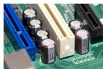
電源ユニットなどコアとなる部分に信頼性が高い日本製の105℃対応のコンデンサーを採用
